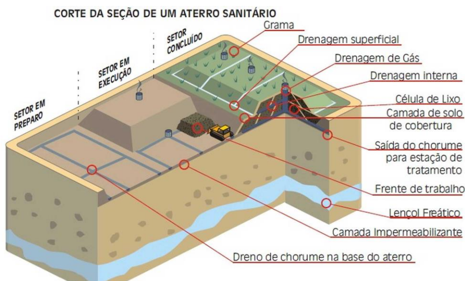
Figura 4 - Infraestrutura de um Aterro Sanitário de resíduos domésticos
